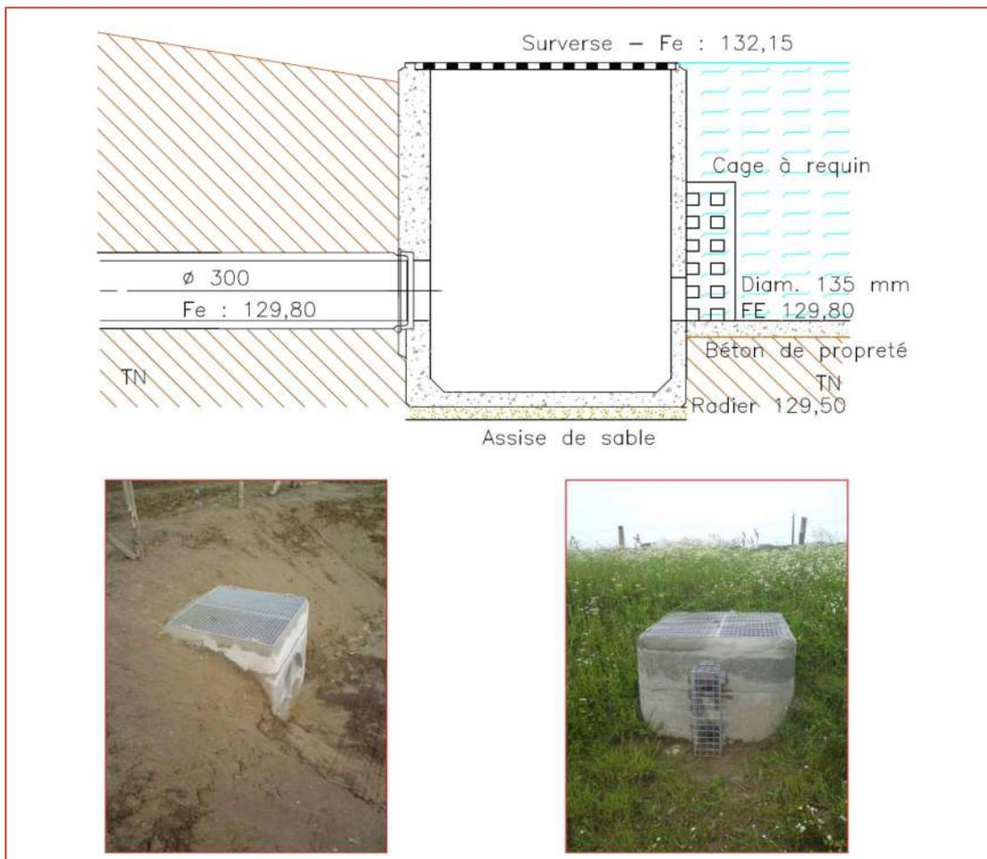
CALCUL D'UN ORIFICE DE FUITE POUR UN OUVRAGE SIPHOIDE - Formule Toricelli
