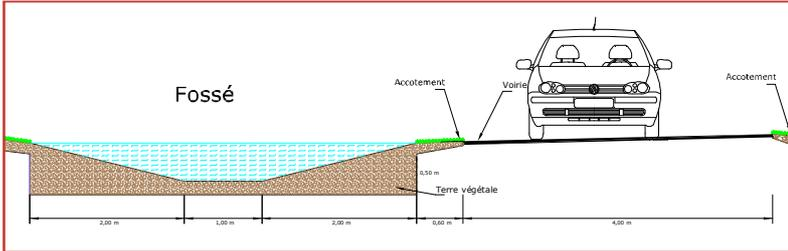
Ouvrage surfacique de stockage / lamination des débits
